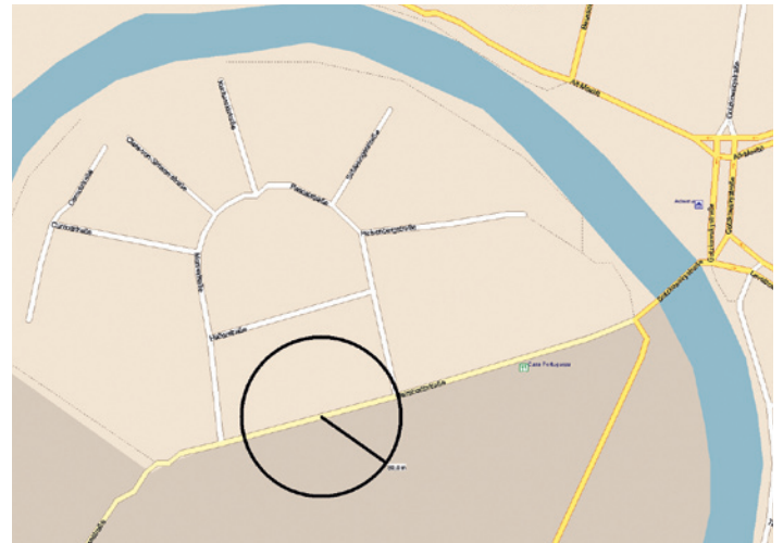
Mit Geo-Fencing lässt sich der Arbeitsbereich der Hubarbeitsbühne eingrenzen.
