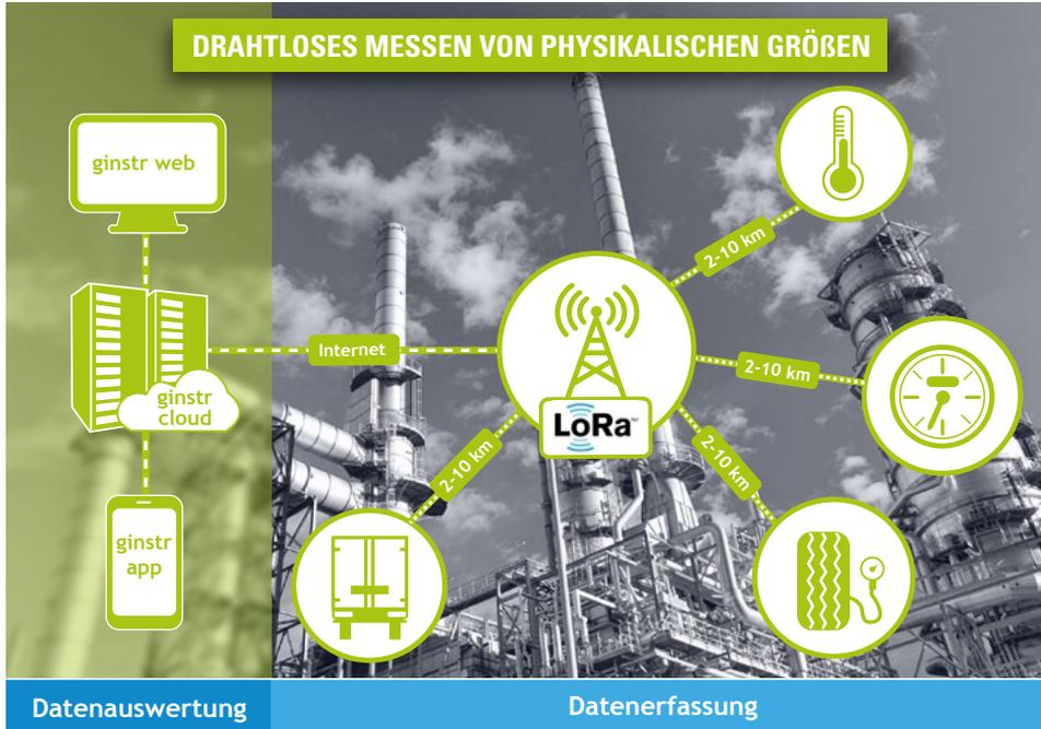
Drahtloses Messen beliebiger physikalischer Größen wie Reifenluftdruck, Temperatur (z.B. in Kammern von Lebensmitteltransportern), Betriebsstunden von Maschinen, Messwerte von Heizkostenverteilern, Zustände von Containertüren u.v.m.
