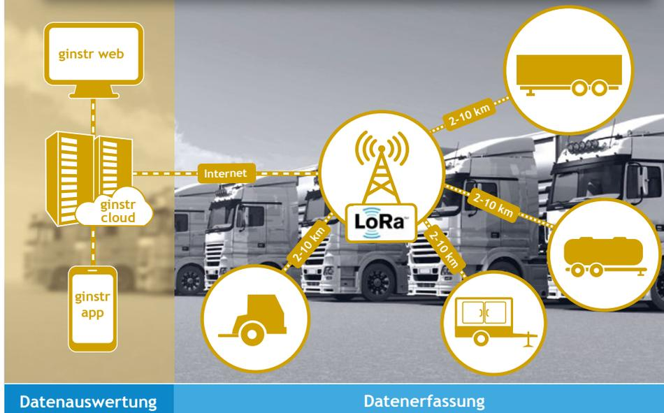
Automatisches Ermitteln, welcher Anhänger gerade an welcher Zugmaschine angehängt ist
