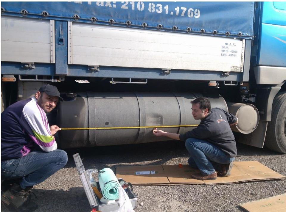
*Imagen 1: Encontrando el centro geométrico del tanque*
