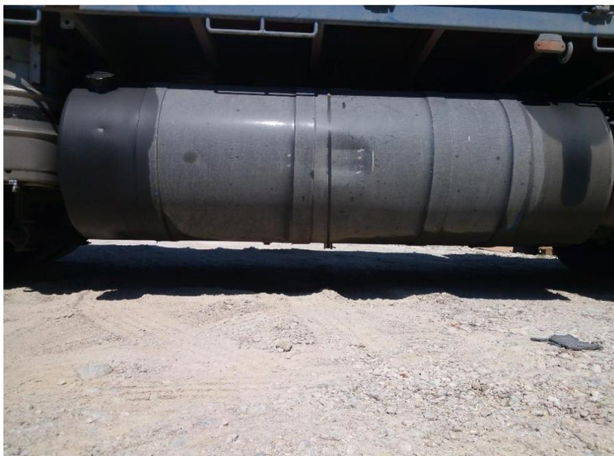
*Illustration 14 : cerchez le capteur avant la fin de la durée d'action de la colle. Utilisez un ruban de cerclage en acier de 16 mm. Cette photo illustre un ruban en plastique. Vous pouvez voir le capteur en dessous du réservoir.*
