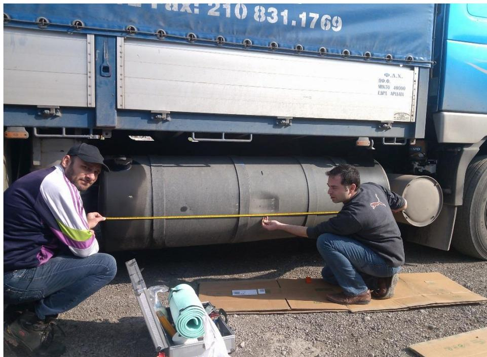
*Illustration 8 : trouver le centre géométrique du réservoir*
