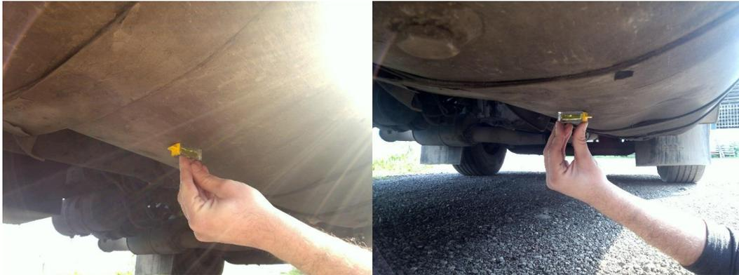
*Illustration 10 : vérifier les deux directions (d'avant en arrière et de gauche à droite) à l'aide d'un niveau pour trouver les sites d'installation horizontaux possibles. Il ne faut pas dépasser une erreur maximale de deux degrés par rapport au niveau horizontal.*
