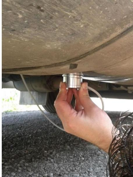
*Illustration 13 : appuyez sur le capteur pour affiner la couche de colle et rapprocher le capteur du fond du réservoir.*
