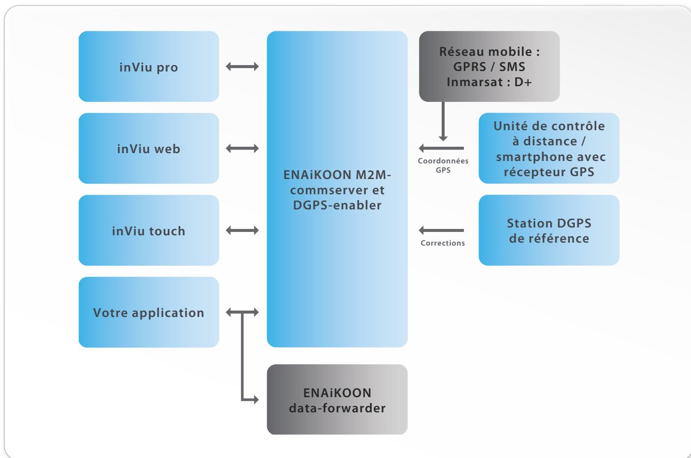
Puisque la précision d'un GPS est variable, le service ENAIKOON DGPS-enabler sauvegarde plusieurs fois par minute les nouveaux vecteurs de correction calculés, en horodatant l'action.
